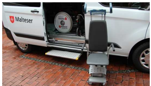
Barrierefreiheit durch Rollstuhl-Hublift, und Treppensteighilfe
